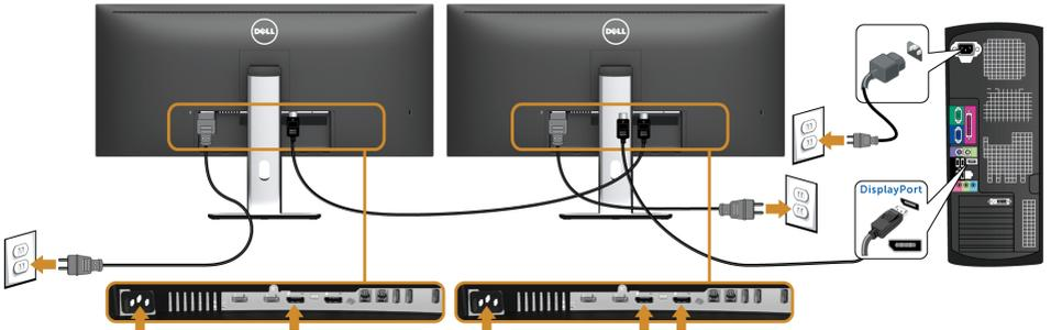
**ملاحظة:** يدعم U3415W خاصية النقل عبر التدفق المتعدد (DP MST). للاستفادة من هذه الخاصية، يجب أن تتوافق بطاقة الرسوم الخاصة بجهاز الكمبيوتر مع DP 1.2 بخيار النقل عبر التدفق المتعدد (MST).
