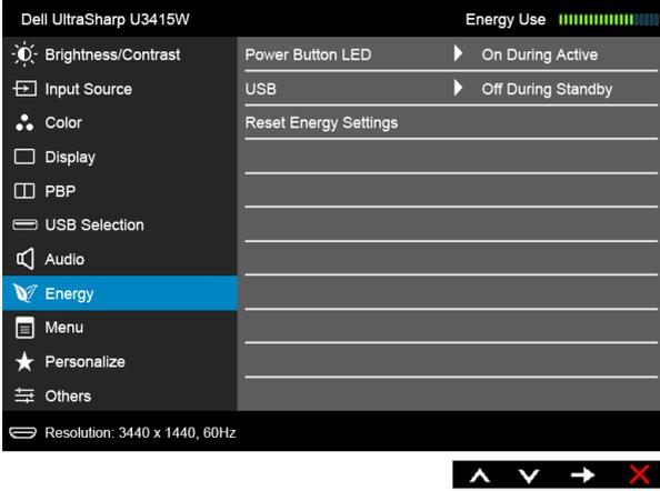
تتيح لك تشغيل أو إيقاف ضبط مؤشر LED للطاقة لتوفير الطاقة.
